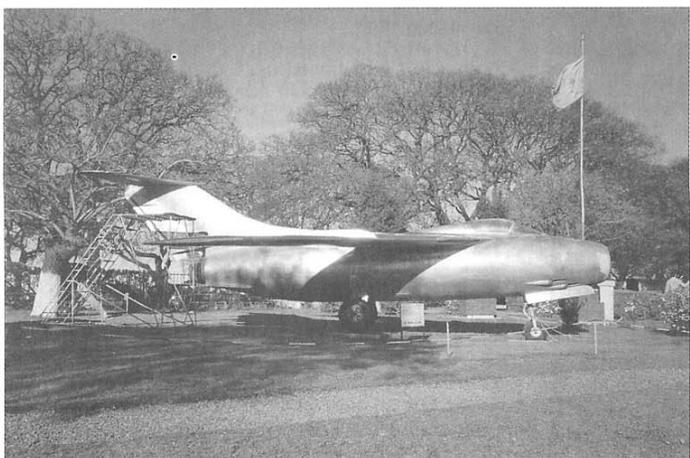
**L'IAe-33 "Pulqui II". Progettato dal famoso Ing. Kurt Tank, direttore tecnico della Focke Wulf durante la seconda guerra mondiale, il Pulqui II volò per la prima volta il 27 giugno del 1950 ma non entrò mai in produzione e rimase allo stadio di prototipo (6 velivoli).**
