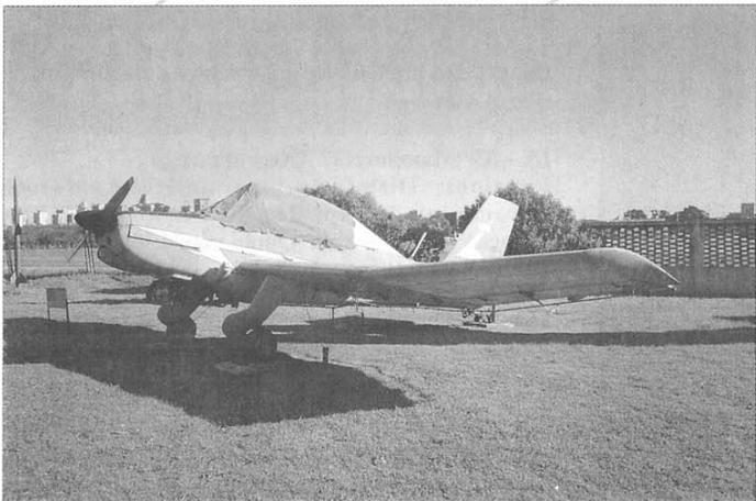
**L'IA-53 DINFIA "Mamboreta" fu il primo velivolo agricolo completamente progettato e costruito in Argentina. Il prototipo volò nel 1966. La struttura era in lega di alluminio mista a fibra di vetro rinforzata da una copertura di plastica in poliestere. HH 3 F Pelikan autocostruito in scala 1/48 da Marco Pisani di Roma.**
