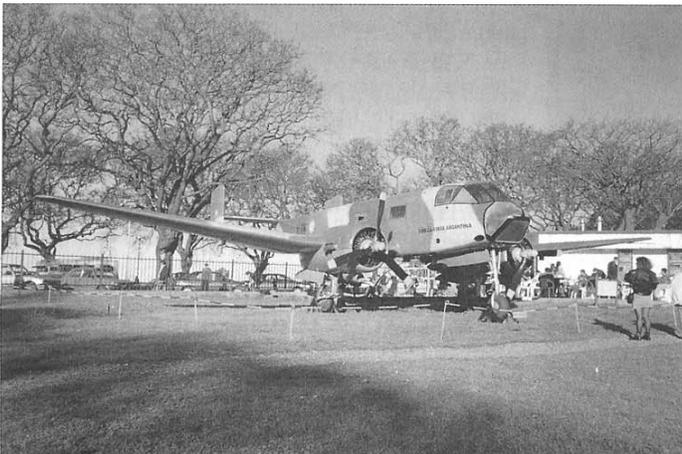
Il bimotore IA-35 "Huanquero" (El Indio). Prodotto dalla I.A.M.E. (Industrias Aeronauticas y Mecanicas del Estado poi rinominata Instituto Aerotécnico) fu concepito come trasporto leggero e bombardiere da addestramento ma, pur vetusto, fu impiegato anche nella battaglia delle Falkland. Il prototipo volò nel 1953 ed entrò in regolare produzione a fine 1955.
