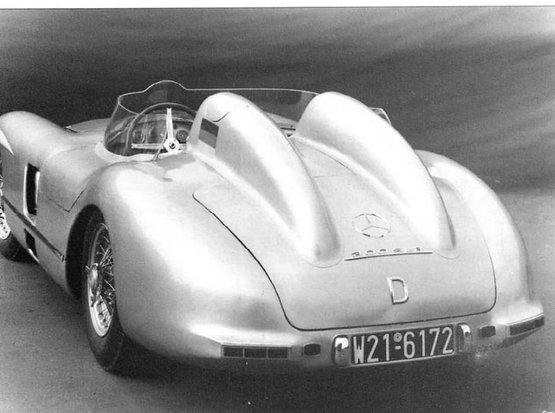
In alto e al centro: Viste anteriore e posteriore dell'esemplare raffigurato a pag. 30; si noti l'imponenza dei due poggiatesta aerodinamici e, su quello sinistro, il portello per accedere al tappo del serbatoio carburante. (foto Arch. Mercedes-Benz)
