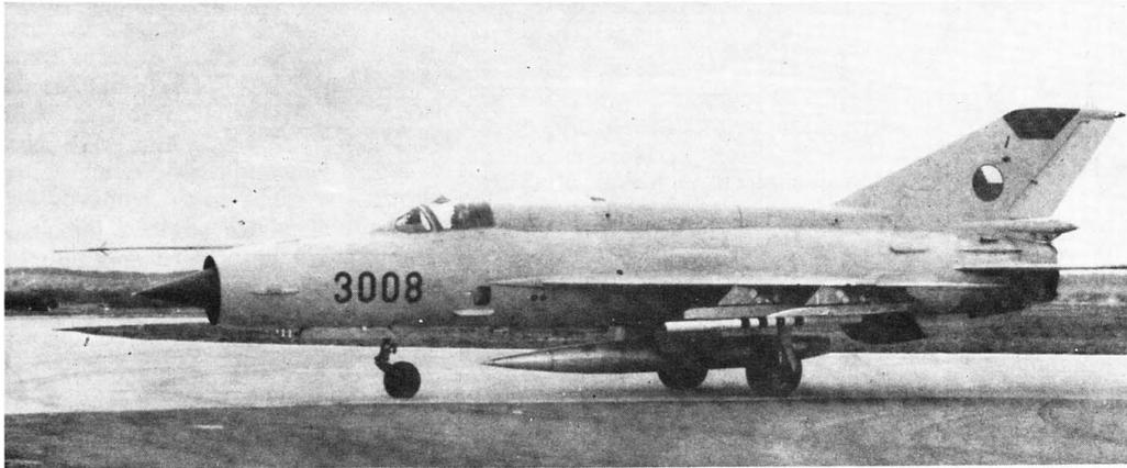
**In alto:** Un intercettore MiG-21MF dell' Aeronautica Cecoslovacca, equipaggiato con un serbatoio supplementare all'attacco ventrale ed un pod per disturbi ECM all'attacco alare interno; da notare che il pod ECM è appeso ad una rotaia di lancio per missili K-13 "Atoll", mentre l'attacco subalare esterno porta una rotaia di lancio per missili K-13A "Advanced Atoll". La colorazione generale è in grigio (simile allo FS-26439). (AZ)
