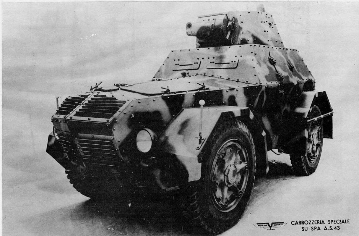
Vista di 3/4 anteriore della autoblinda montata sullo chassis della camionetta A.S. 43. Si possono osservare i dettagli della torretta che è la stessa del carro armato leggero L/40. L'affusto è ancora privo dell'arma. (Foto Viberti)
