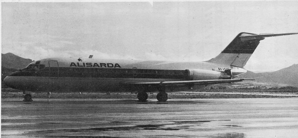
Il DC9/10 I-SARU in servizio presso l'Alisarda. I colori sulla fusoliera e sulla deriva sono, dal basso, viola e rosso separati da una sottile linea gialla. Si notano le conchiglie per l'inversione del flusso dei reattori in posizione di "aperto". (Foto Alisarda)
