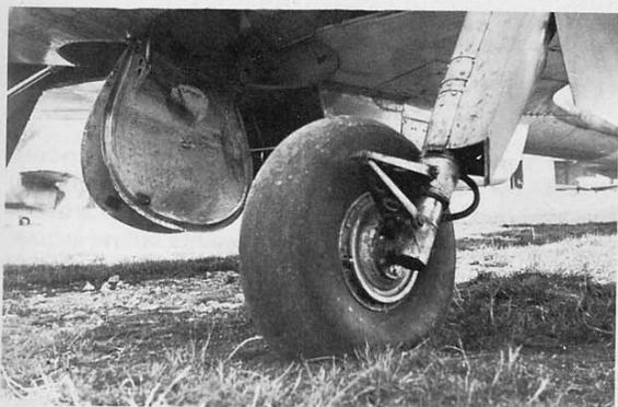
*Primo piano del carrello anteriore da cui si può ricavare la particolare struttura degli elementi che chiudono il vano carrelli; soprattutto insolita è la forma della parte solidale con la gamba. Si noti la zona di separazione sulla fusoliera tra la mimetizzazione superiore e inferiore. (Foto Museo Caproni)*
