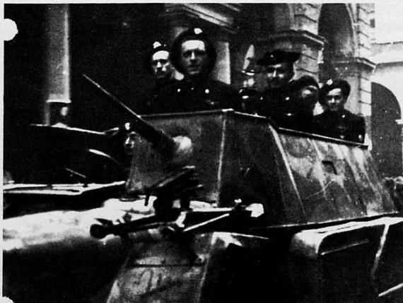
Rara instantanea dell'autoprotetto a cielo scoperto cui si fa riferimento nel testo. Questo veicolo, basato sullo stesso telaio della AS 43, montava sempre la Breda 37, ma su un attacco a giunto sferico. Sul parafrangente si nota il treppiede per l'impiego a terra della stessa arma. Il mezzo è in forza alla Guardia Nazionale Repubblicana, Gruppo Leonessa come si rileva dal distintivo della "M" attraversata obliquamente dal fascio. La foto dovrebbe essere stata ripresa a Torino il 26/2/1945.
