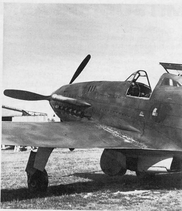
*Di nuovo una vista di 3/4 posteriore utile per vari dettagli quali il radiatore ventrale, l'attacco posteriore delle ali e le pale dell'elica. (Foto Museo Caproni)*
