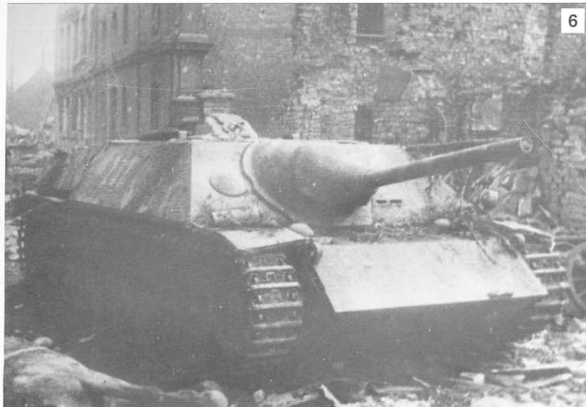
Zimmerit e i due tubi di adduzione aria accanto allo scarico sinistro. Il vano motore e il treno di rotolamento hanno preso fuoco.
